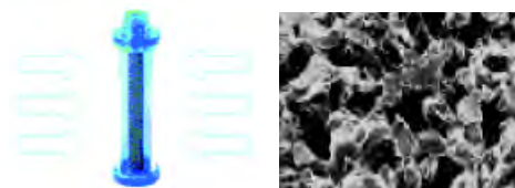
Figura 7. Campionatore passivo. A destra, fotografia al microscopio elettronico (SEM) della superficie diffusiva.
